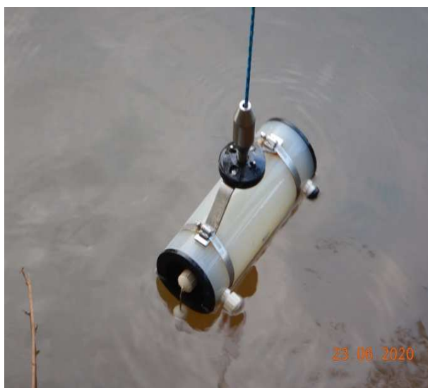
Foto 7 – Detalhe do equipamento utilizado (Garrafa de Van Dorn) para a coleta de água superficial. (Data: 22/06/2020).
