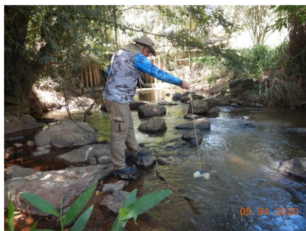
Foto 3.2.1-2. Utilização do disco de Secchi para aferir a transparência.
